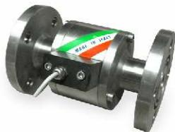
**CPO** : Contalitri volumetrico a disco nutante, idoneo per il dosaggio di liquidi alimentari. Buona affidabilità, semplice design. 1% di precisione sul prodotto dosato. Corpo in AISI, pistone in Telon .Lancia impulsi REED. Su richiesta attacchi langiati e camera di preriscaldo.
