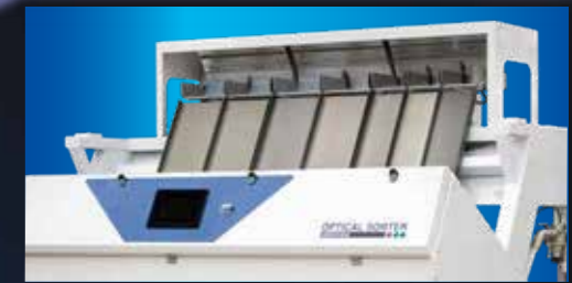
Stabilne doprowadzenie materiałów sortowanych do sekcji optycznej
